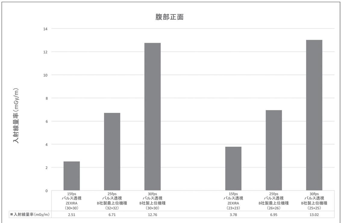
図4 実臨床の条件における各装置の透視線量実測値の比較(腹部領域)
